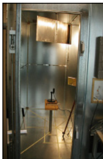
Chambre réverbérante qui permet de tester l'immunité électromagnétique de composants dans le cadre des tests de compatibilité électromagnétique Source : CNRS
