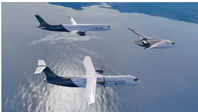
Les trois modèles à hydrogène d'Airbus fonctionnant avec des turbines à gaz. Source : Airbus
