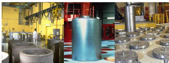
De gauche à droite : cellule de coulée des conteneurs béton et fibre pour les déchets de faible activité à La Hague; conteneur de déchets vitrifiés; installation d'entreposage Cascad à Cadarache.
