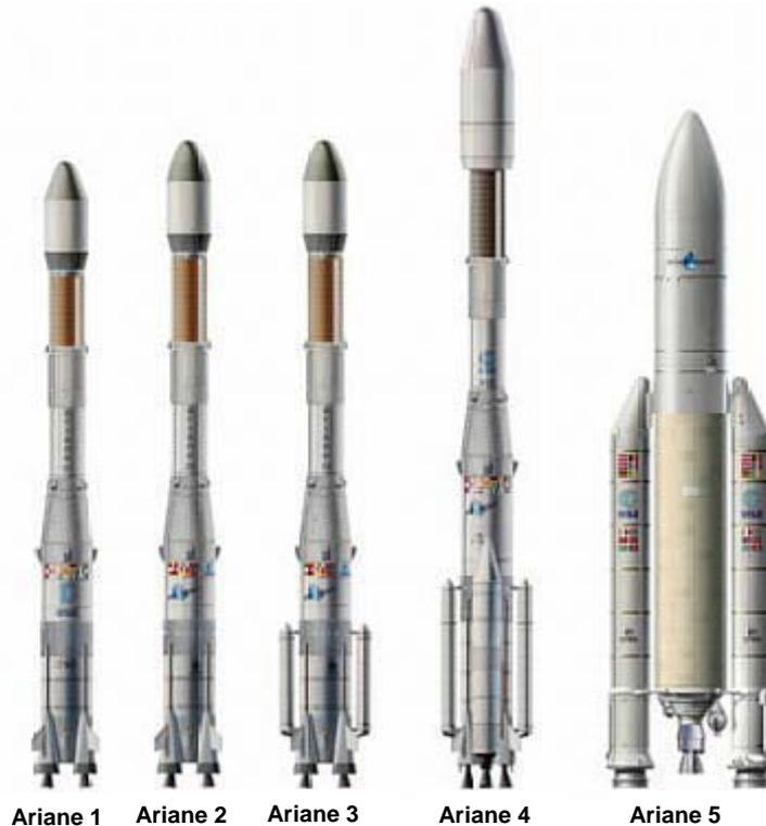
Ariane 5 est constituée de deux boosters à propulsion solide (étages à poudre ou EAP) et de deux étages à propulsion cryogénique (hydrogène et oxygène liquides) :
